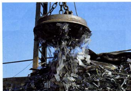
Esta grúa utiliza el magnetismo para mover la chatarra. Contiene un potente imán.
